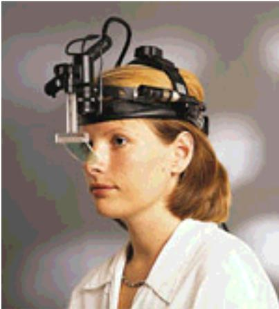
**Bild 3:** Headmounted Eyetracking Device (Foto: SMI)
