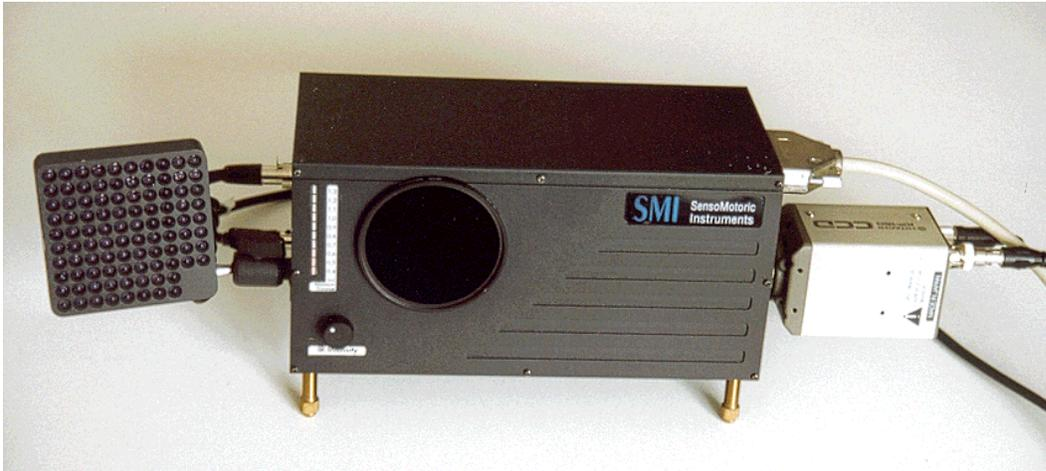
**Bild 1:** Das Remote Eyetracking Device von SMI
