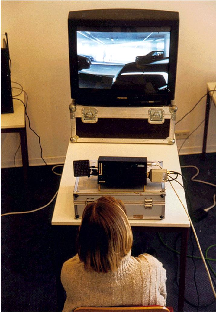
**Bild 4:** Proband vor Monitor und Remote Eyetracking Device
